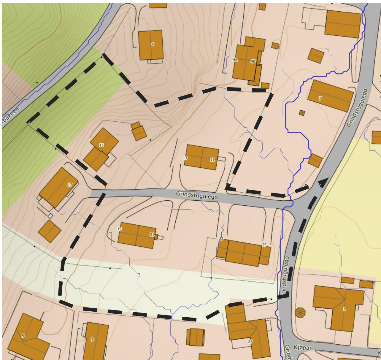
Figur 5. Drenslinjer (>500 m 2 ) for planområdet er vist som blå streker. Ca. plassering av plangrense er vist med stipla linje.
