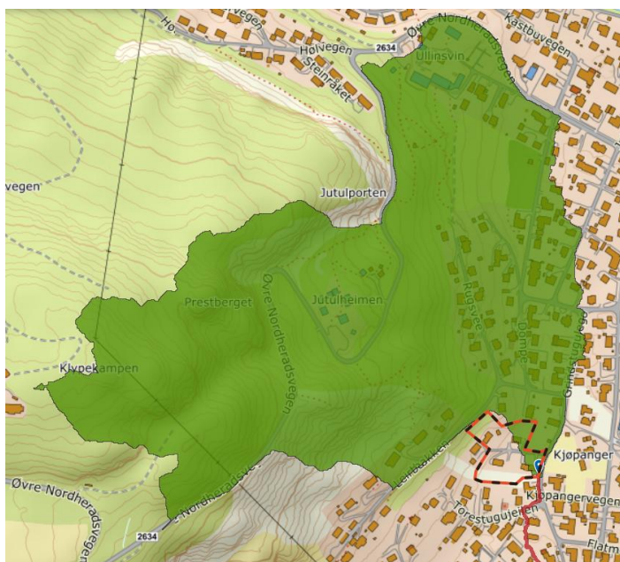
Figur 7. Nedbørfelt til flomvei som renner gjennom planområdet i øst.
