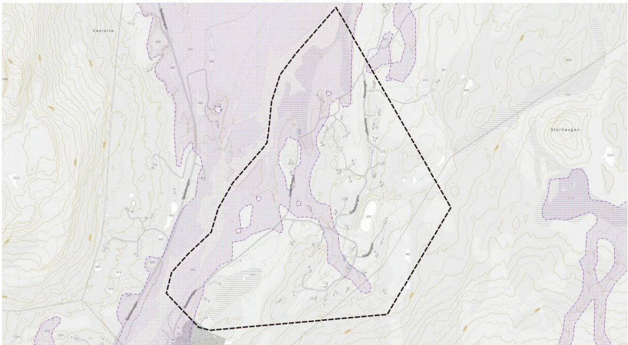
Figur 2 Utsnittet viser aktsomhetsområde for flom. Planområdet er grovt angitt med svart stiplet strek. Kilde: NVE.
