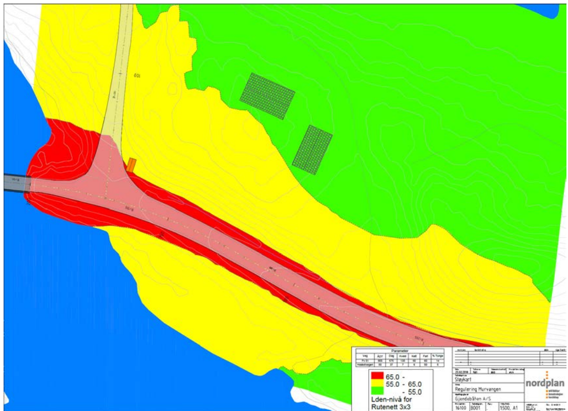
Figur 20. Nedkopierte kart som syner støyutbreiing ifm. trafikkstøy frå Fv. 51 og Hoskelivegen. Planlagde bygningar i planforslaget er vist med skravert figur.
