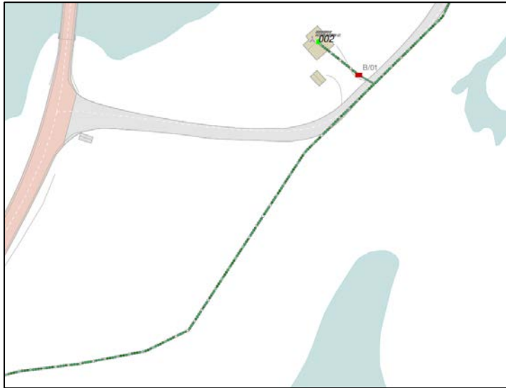
Figur 19. Lågspentkabel gjennom planområdet og kabelskap merkt (B/01) nord for Hoskelivegen. Kjelde: Eidefoss.
