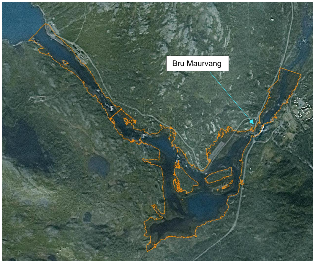
Figur 3-3: Flomsone ved 200-årsflom med klimapåslag
