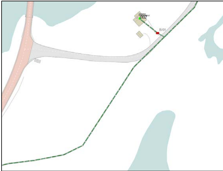
Figur 19. Lågspenkabel gjennom planområdet og kabelskap merkt (B/01) nord for Hoskelivegen. Kjelde: Eidefoss.
