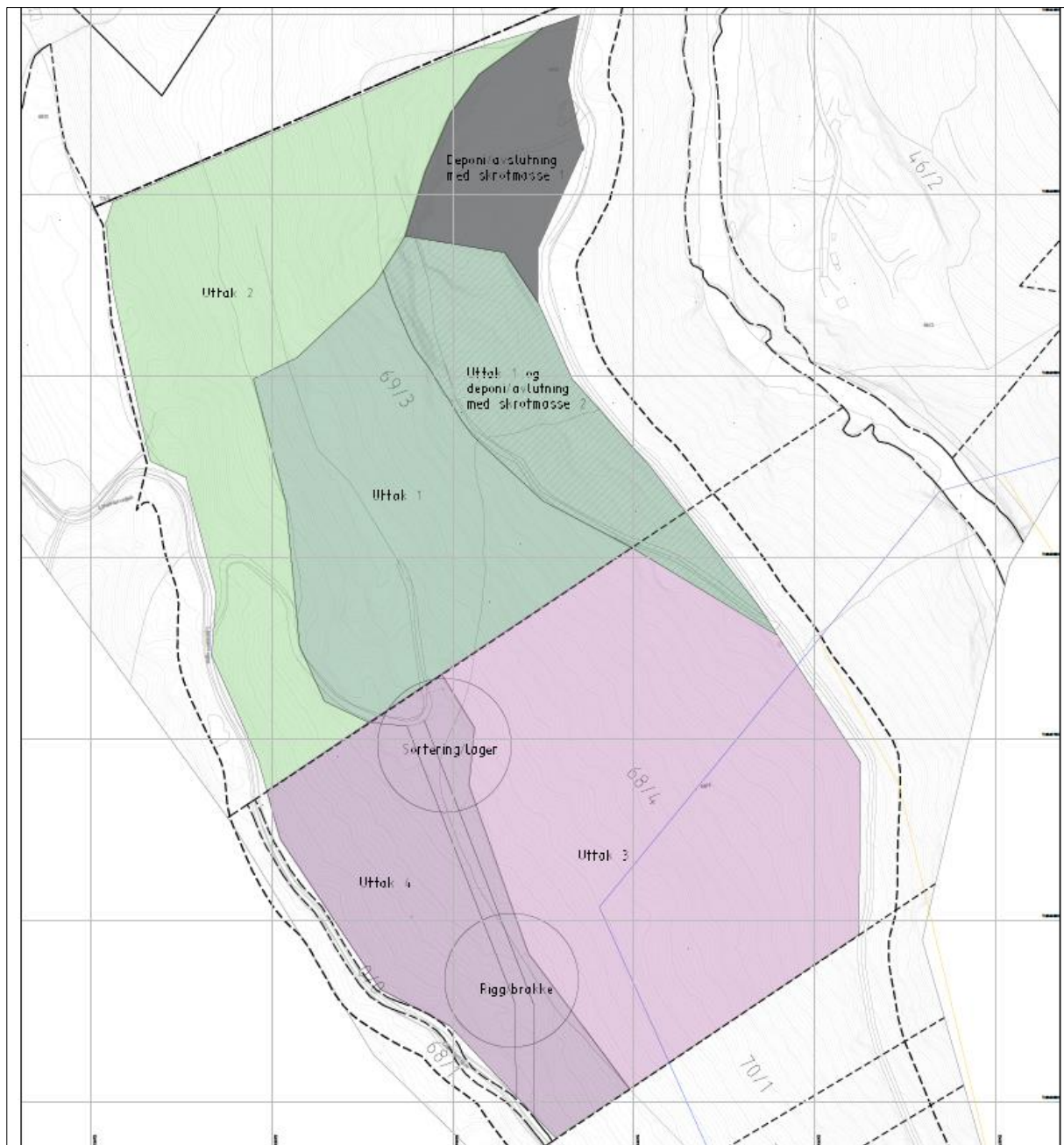
Figur 2: Kart som viser kvar det skal hentast ut massar og plassering av riggbrakke. Teikna 24.01.2019 av Nordplan AS. Plassering av riggbrakke kan endrast.
