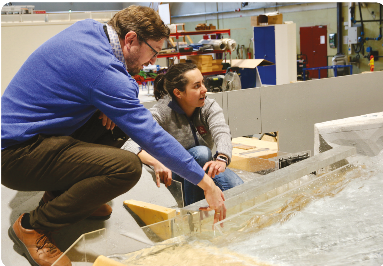
Senioringeniør Priska H. Hiller representerer NVE, oppdragsgiver for prosjektet. Her prøver hun ut ulike konstruksjoner i terskelen for inntaket sammen med forsker Geir Helge Kiplesund. Hiller har sin doktorgrad fra Vassdragslaboratoriet.
